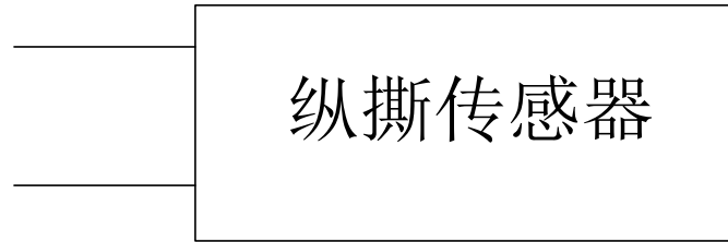
图-10 纵撕传感器的接线方法如上图所示：如果接到控制器里，就直接接到控制器的输入端的“IN”和 12v 电源上；如果接到下位机里，还需要在输入端串接一个 1K 和并联一个 22K 的电阻。（纵撕传感器在控制器和下位机里的接线主法与跑偏传感器相同。）
