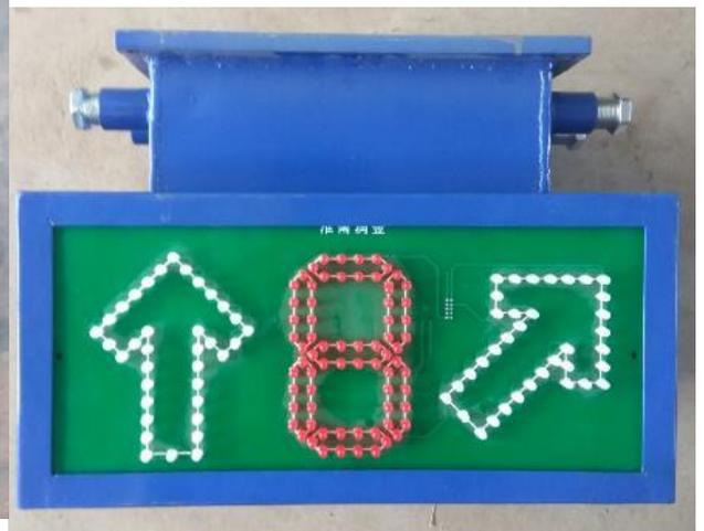
道岔用报警器有两种：左转弯直行和直行右转弯。使用单位订货时要注明是那种，例如：道岔报警器左转弯直行一台，型号 KXB127T。
